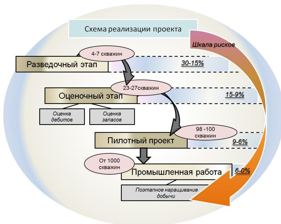
Рис. 16. Принципиальная схема объемов работ при реализации этапов проекта по освоению сланцевого УВС
