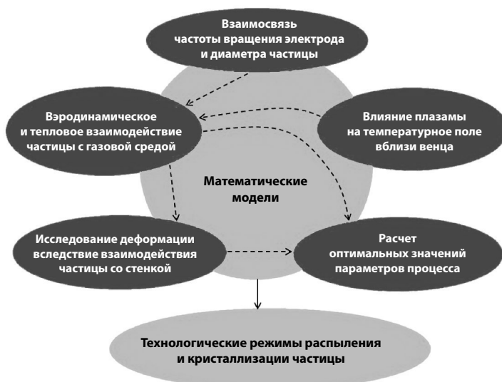
Рис. 1. Моделирование процесса получения гранул методом PREP
