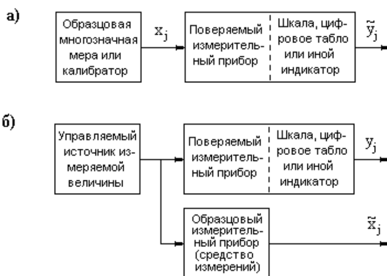
Рис. 1.10. Схемы поверки измерительного прибора: а) методом «по мере»; б) методом «по образцовому прибору»
