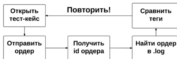
Рис. 2. Процесс ручного тестирования
