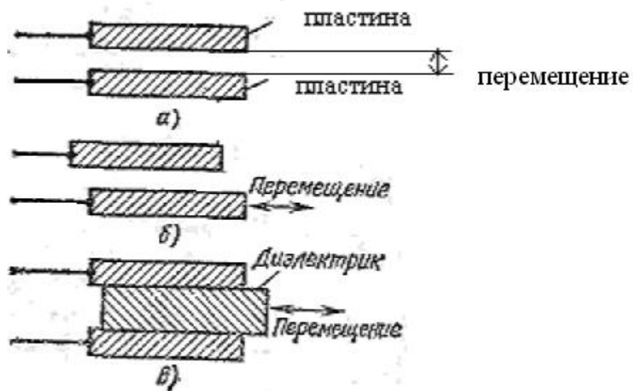
Рис.2.22.Принцип действия емкостных преобразователей
