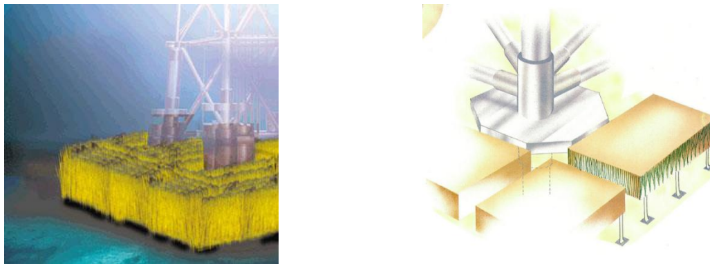
Рисунок 8. Устройство защитного покрытия из матов с искусственными водорослями [27]
