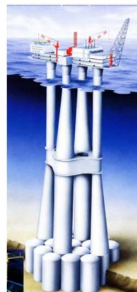
Рисунок 12. Самозасасывающиеся юбочные основания:
