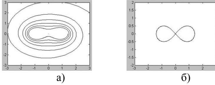
Рис. 5. Графики зависимости  $y_2$  от  $y_1$  (метод Эйлера с шагом дискретизации 0.5,  $u_1 = 0.01$ ) без коррекции (а) и с коррекцией (б)
