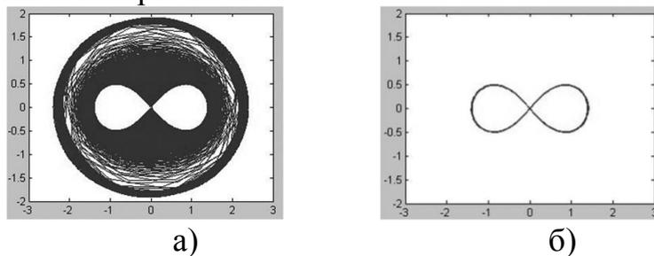
Рис. 4. Графики зависимости  $y_2$  от  $y_1$  (метод Dormand-Prince с шагом дискретизации  $0.05$ ,  $u_1 = 1$ ) без коррекции (а) и с коррекцией (б)
