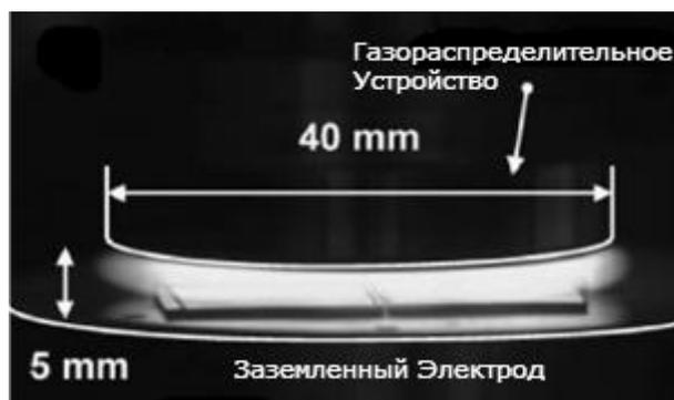
Рис. 1.28 – Фотография ВЧ-разряда при атмосферном давлении [97]
