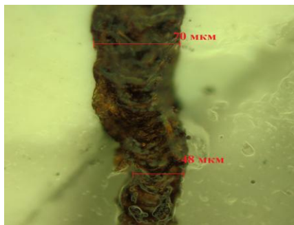
Рис. 8. Медная дорожка на поверхности образца ( \text{SiO}_2 (93%) \text{Al}_2\text{O}_3 (7%) vs. \text{SiO}_2 ). Мощность лазерного излучения 1200 мВт. Увеличение 20х.
