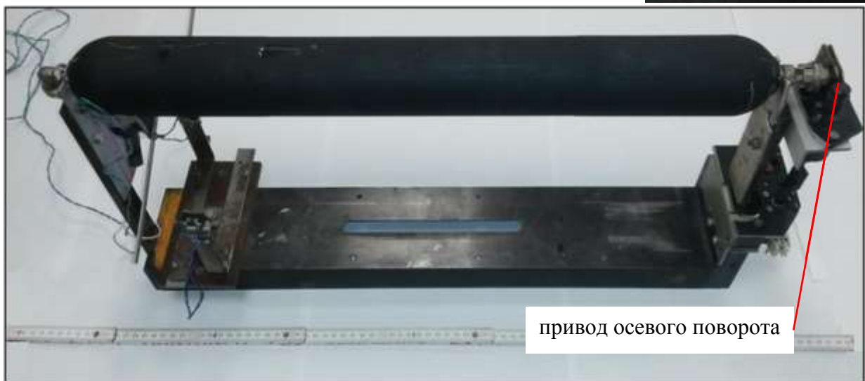
Рисунок 2.7 – Схема (а) и общий вид (б) модели обогреваемого паром цилиндра
