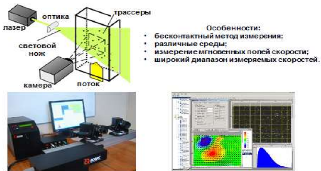
Рисунок 2.10 – PIV система ПОЛИС (ИТФ СО РАН, г. Новосибирск)
