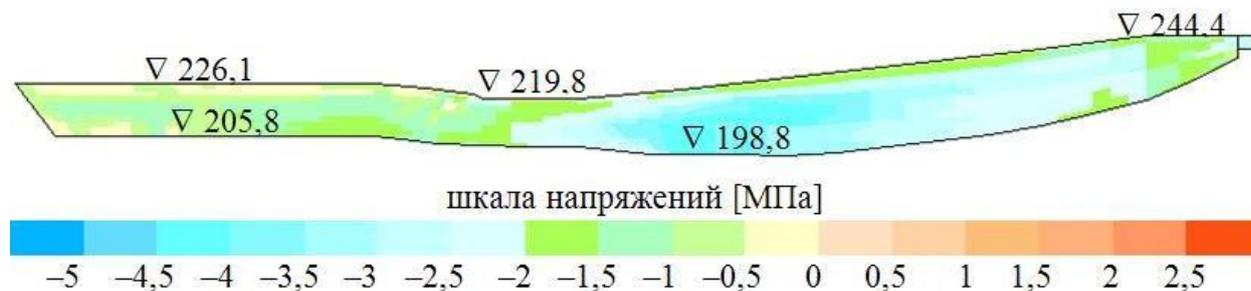
Рисунок 12. Распределение главных напряжений  $\sigma_3$  в стене в грунте в сечении по створу
