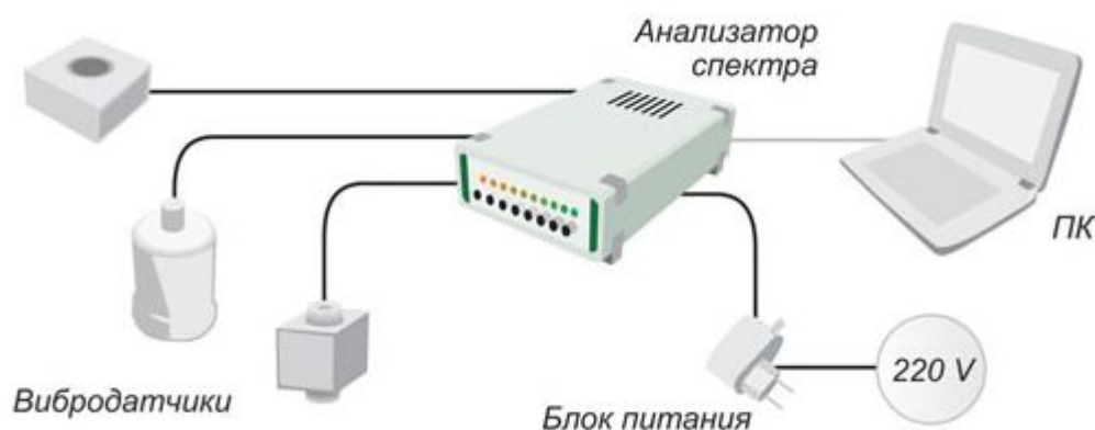
Рис. 1. Схема снятия показаний вибрации
