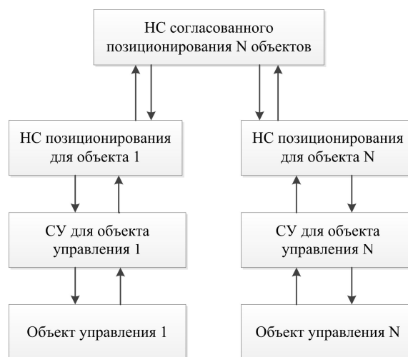
Рис. 2. Схема использования нейронной сети позиционирования для управления несколькими объектами
