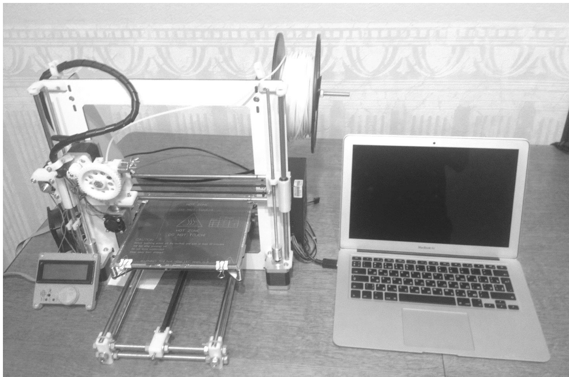
Рис. 1. 3D-принтер для изготовления моделей штамповой оснастки
