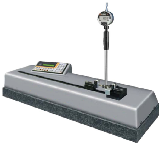
Рис. 1. Прибор для поверки двухточечного измерительного инструмента М1000
