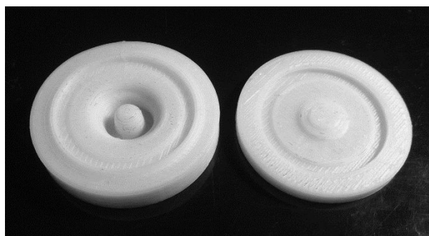
Рис.2. Модели формообразующих элементов штамповой оснастки, изготовленные на 3-D принтере
