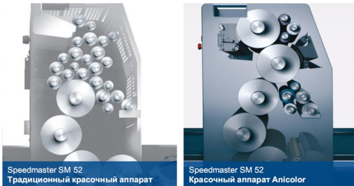
Рис. 1. Сравнение конструкций традиционного красочного аппарата и красочного аппарата Anicolor
