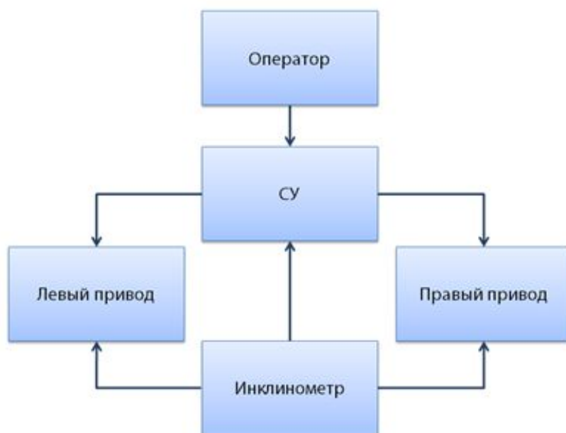
Рис. 2. Упрощенная структура системы управления устройством
