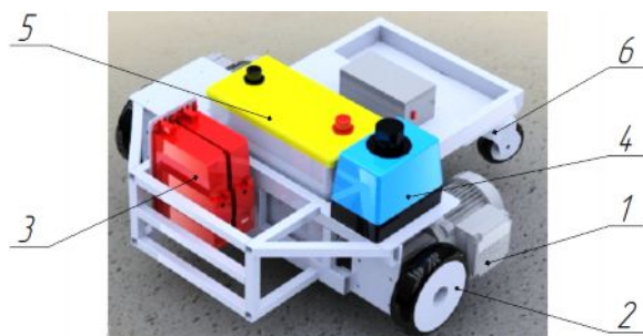
Рис. 1. 3D-модель макета двухприводного робота (1 – мотор-редуктор SEW-Eurodrive; 2 – приводное колесо; 3 – частотный преобразователь SEW-Eurodrive; 4 – SickLidarNAV200; 5 – аккумулятор 12В; 6 – трехколесная подвижная опора)
