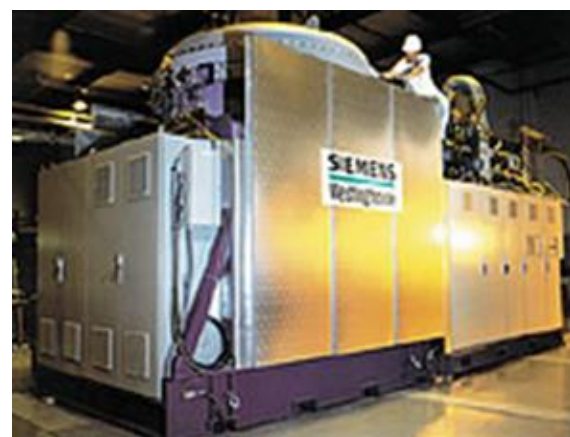
Рисунок П.1.19. 220-кВт гибридная установка с генератором на основе твердооксидного топливного элемента (SOFC) компании «Siemens»
