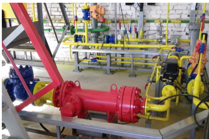
Рисунок 7.46. Установка для проведения для натурных исследований расширительных турбин турбогенераторов малой мощности (ТГММ - УСЖГ)
