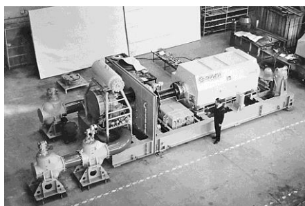
Рисунок П.2.5. Детандерная утилизационная энергетическая установка ( N_3 = 5 \text{ МВт} )
