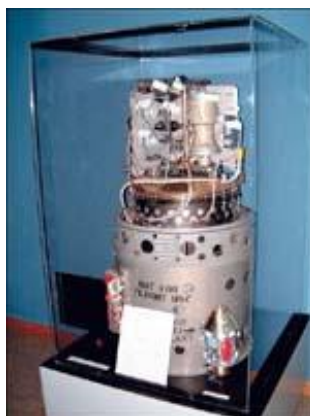
Рисунок П.1.14. Топливный элемент на основе расплавленного карбоната (MCFC), установленный на космическом корабле «Apollo» (экспонат Музея космической истории, Аламогордо, штат Нью-Мексико, США)
