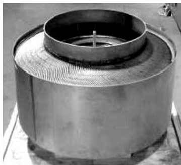
Рисунок П.1.50. Вид на рекуператор
