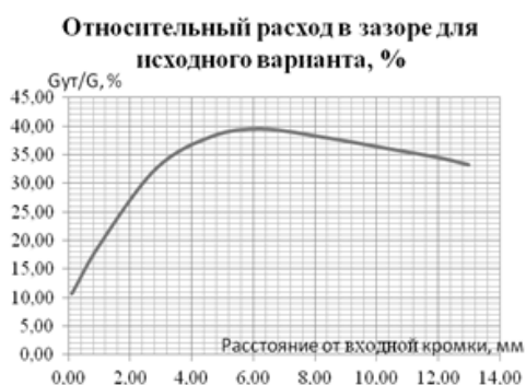
Рисунок 6.11. Изменение относительного расхода через радиальный зазор над РК в зависимости от расстояния от входной кромки
