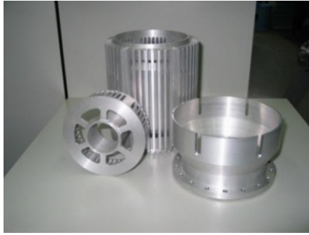
Рисунок 7.48. Статорные детали высокооборотного электрогенератора
