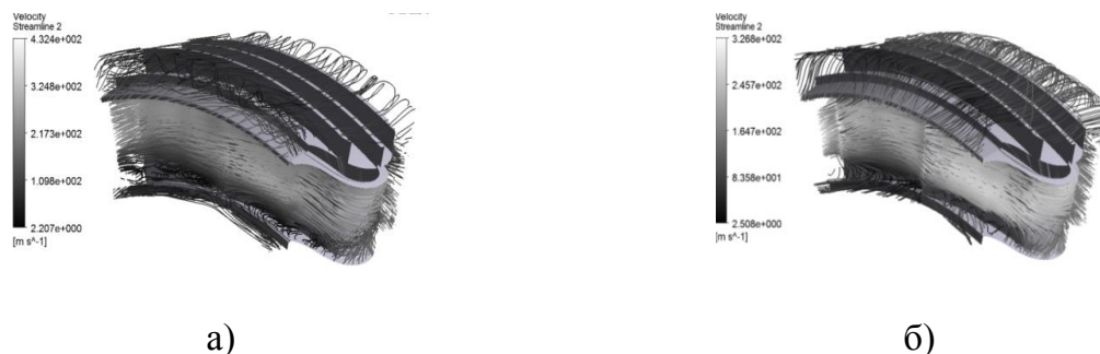
Рисунок 6.23. Линии тока на входе в проточную часть РК и в радиальном зазоре:
