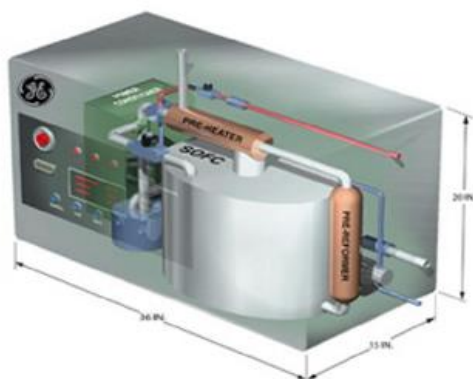
Рисунок П.1.20. Гибридная установка SOFC/GT производства компании General Electric (США)
