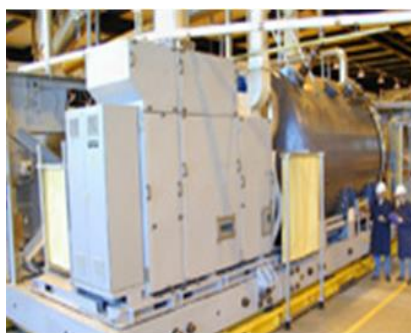
Рисунок П.1.22. 300-кВт гибридная система SOFC/GT, представленная в Питсбурге, штат Пенсильвания (США)
