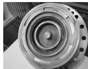
Рисунок 32. Сопловой аппарат расширительной турбины ТГ малой мощности
