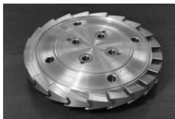
Рисунок 31. Рабочее колесо расширительной турбины ТГ малой мощности
