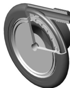
Рисунок 18. Трёхмерная модель микротурбогенератора (МТГ-1) (ООО Газразделение)
