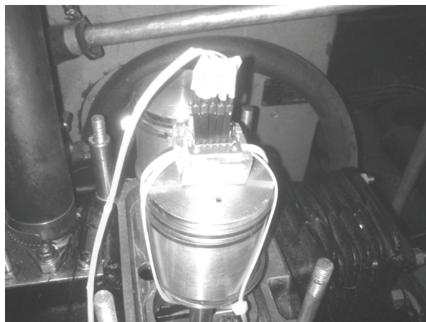
Рис. 6. Поршень с установленным датчиком
