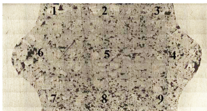
Рис. 17. Макроструктура порошковой заготовки после деформации 45 % (пористость: 1 – 0,259; 2 – 0,201; 3 – 0,234; 4 – 0,287; 5 – 0,226; 6 – 0,268; 7 – 0,262; 8 – 0,340; 9 – 0,247)
