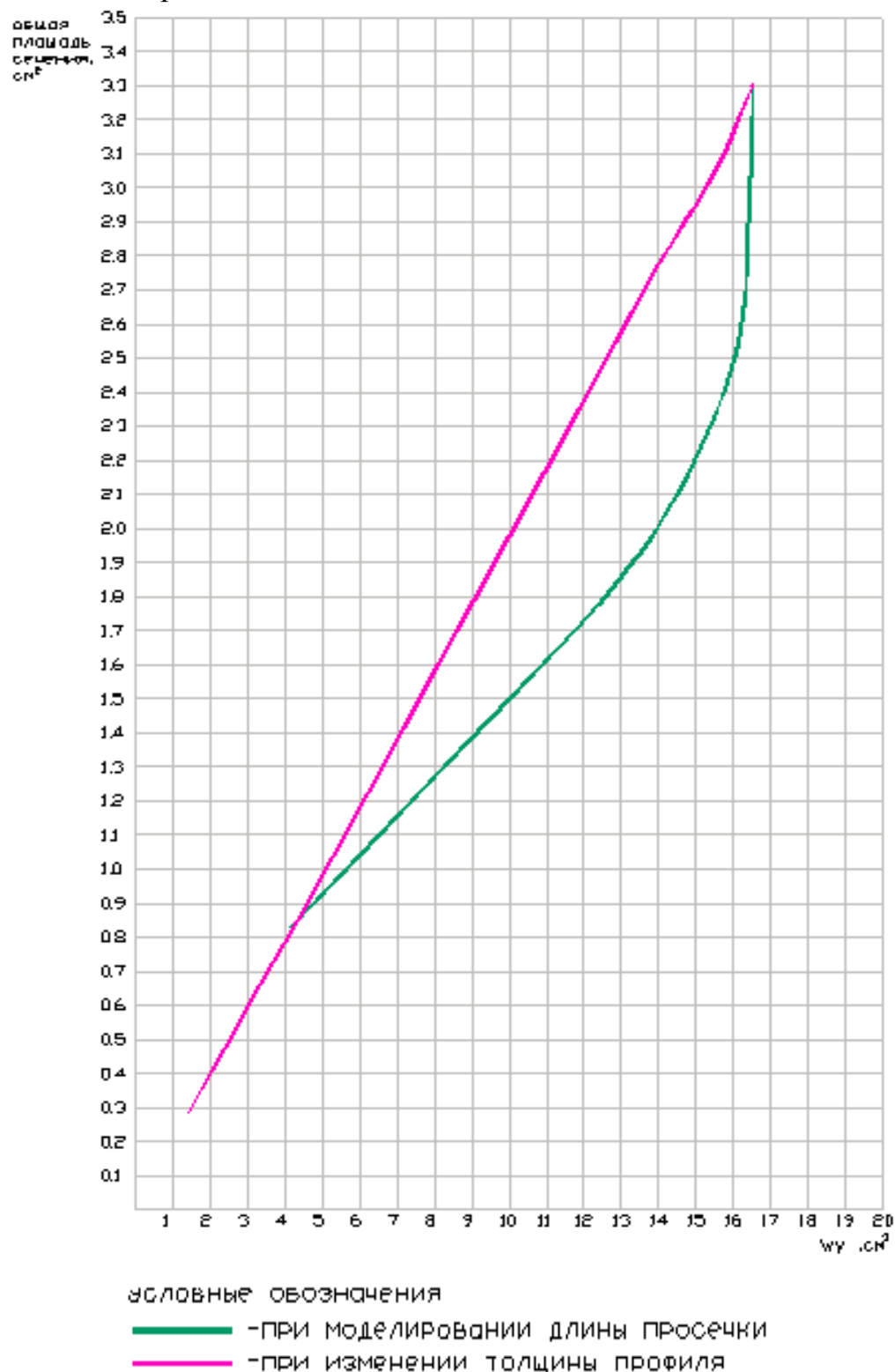
Рис. 1.64. Графики зависимости момента сопротивления от площади сечения стержня
