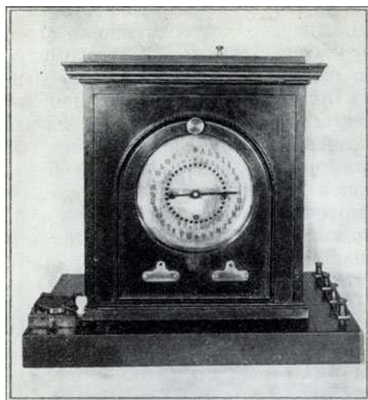
Рис. 2.36. Аппарат Б.С. Якоби с шаговым движением стрелки
