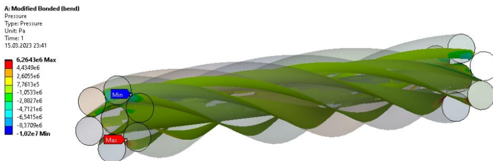
Рис. 8. Поперечный изгиб каната. Контактное давление, Па, в модели с жесткой связью по линиям
