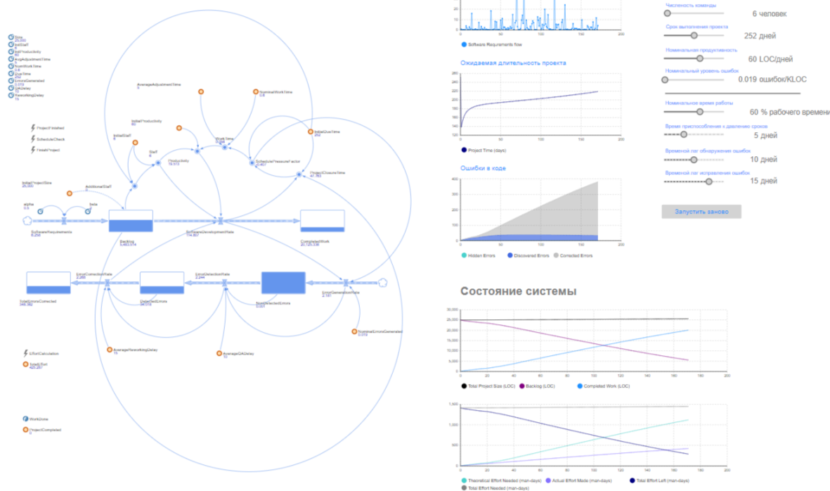
Рис. 2. Модель процесса конструирования ПО в среде AnyLogic
