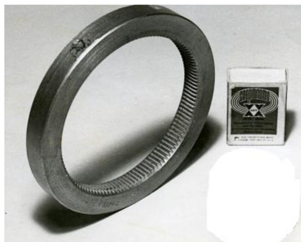
Рис. 3. Жесткое колесо волновой передачи с накатанным внутренним зубчатым профилем высотой 2 мм (сталь 20) [4]
