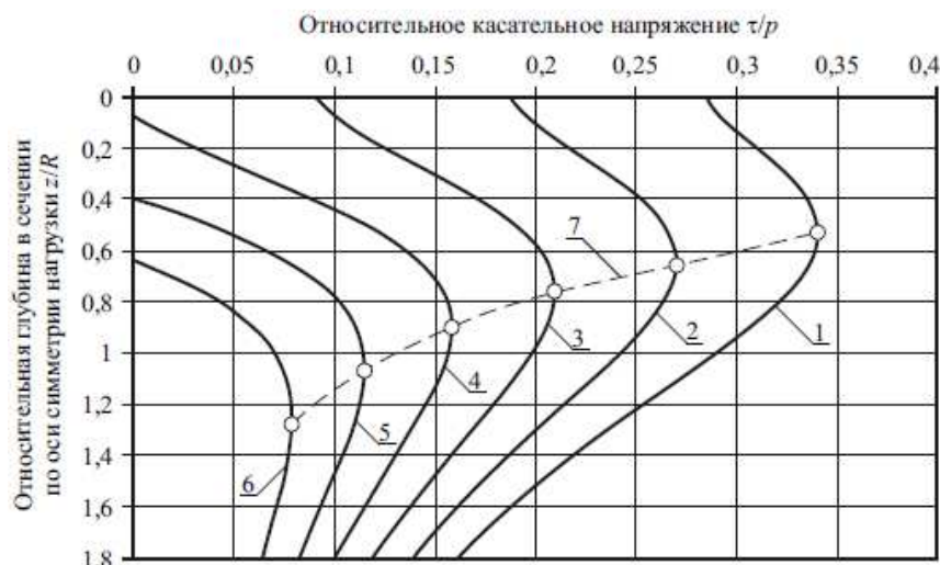
Рисунок 3. Зависимость относительной величины касательных напряжений \tau/\rho , вычисляемых по формуле (2) при d = 0.4 и расчете главных напряжений по модифицированной модели Лява – Фрелиха – Олсона (табл. 1) при n = 3 , от относительной глубины z/R и угла внутреннего трения \phi : 1 – 6 при угле внутреннего трения \phi 0; 10; 20; 30; 40 и 50 °; 7 – линия местоположения наиболее опасных точек
