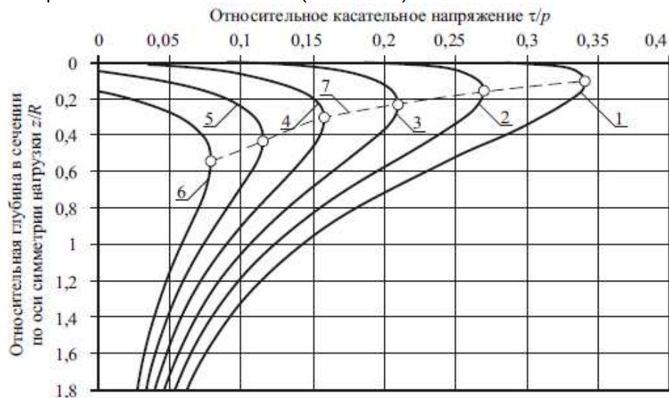
Рисунок 2. Зависимость относительной величины касательных напряжений \tau/p , вычисляемых по формуле (2) при d = 0.4 и расчете главных напряжений по модифицированной модели Лява – Фрелиха – Олсона (табл. 1) при n = 1 , от относительной глубины z/R и угла внутреннего трения \phi : 1 – 6 при угле внутреннего трения \phi 0; 10; 20; 30; 40 и 50 °; 7 – линия местоположения наиболее опасных точек
