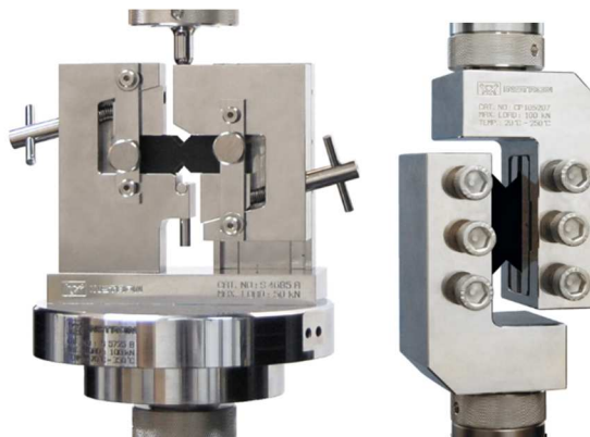
Рисунок 1. Оборудование для методов Iosipescu (слева) и V-Notched Rail Shear (справа)
