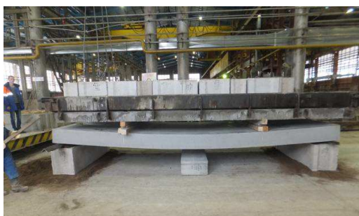
Рисунок 6. Испытания плит ПЦ-80. а) Контрольная нагрузка по трещиностойкости 16 т. Ширина раскрытия трещин до 1.9 мм. б) Нагрузка 34.2 т, предшествующая разрушающей
