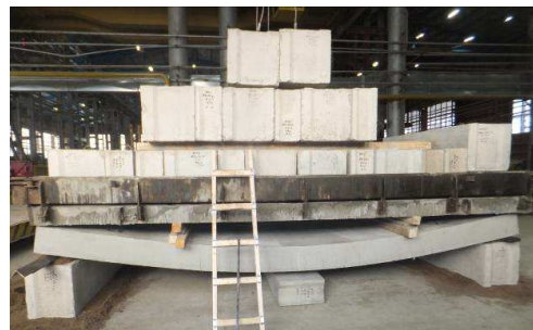
Рисунок 6. Испытания плит ПЦ-80. а) Контрольная нагрузка по трещиностойкости 16 т. Ширина раскрытия трещин до 1.9 мм. б) Нагрузка 34.2 т, предшествующая разрушающей
