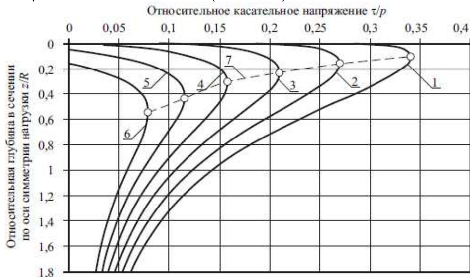
**Рисунок 2. Зависимость относительной величины касательных напряжений  $\tau/p$ , вычисляемых по формуле (2) при  $d = 0.4$  и расчете главных напряжений по модифицированной модели Лява – Фрелиха – Олсона (табл. 1) при  $n = 1$ , от относительной глубины  $z/R$  и угла внутреннего трения  $\varphi$ : 1 – 6 при угле внутреннего трения  $\varphi$  0; 10; 20; 30; 40 и 50 °; 7 – линия местоположения наиболее опасных точек**
