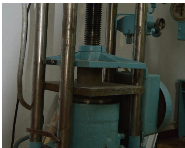
Рисунок 3. Испытание бетонных образцов на прочностные характеристики
