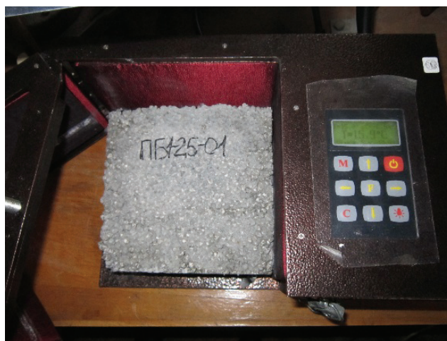
Рисунок 4. Испытание бетонных образцов на теплотехнические характеристики
