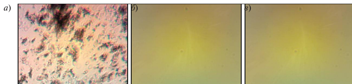
Рис. 4. Микрофотографии ( \times 400 ) проб трансформаторного масла марки ГК после термостарения при температуре 140 °С в течение 152 часов в контакте с медной спиралью (а), а также — с медной спиралью и ЭИБ из 100 % БЦ (б) и 100% РЦ (в)
