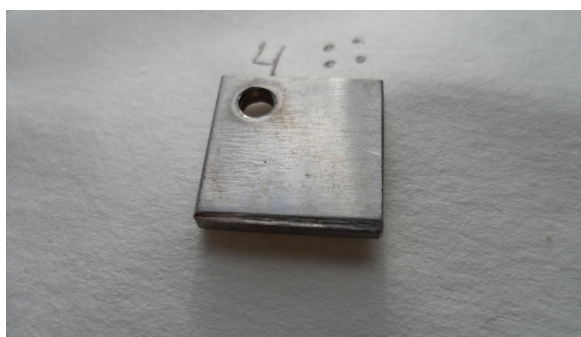
Рис. 1. Поверхность образцов из стали X16H11M3 после испытаний в 3%-м растворе \text{NaCl} длительностью 1013 ч
