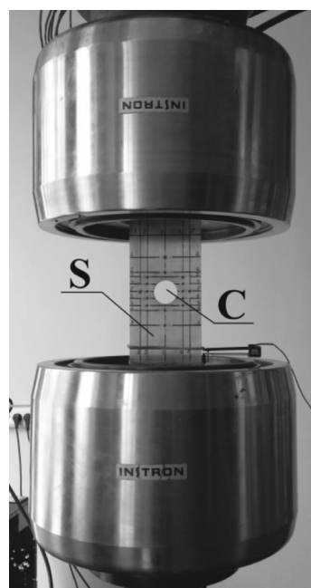
Рис. 2. Общий вид испытательной машины с образцом (S), имеющим концентратор (C), перед проведением испытаний
