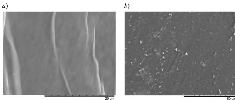
Рис. 1. Микрофотографии поверхности НКЦ (а) и нанокompозита НКЦ – КЮ<sub>3</sub> (b) (использован электронный микроскоп Hitachi ТМ-1000)
