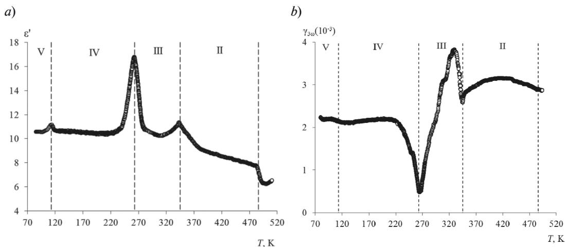
Рис. 2. Температурные зависимости вещественной части диэлектрической проницаемости (а) и коэффициента третьей гармоники (b) поликристаллического иодата калия. Температурные границы фаз показаны пунктиром
