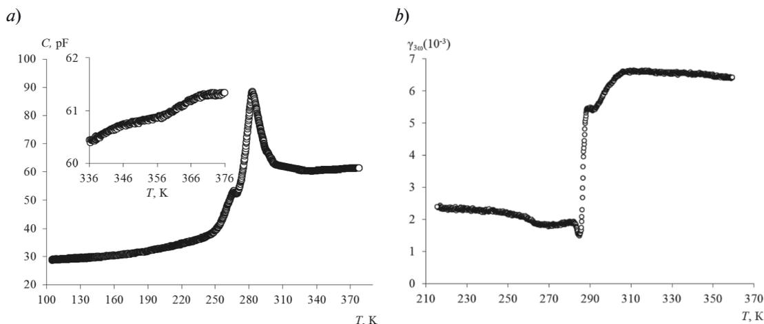
Рис. 3. Температурные зависимости емкости (а) и коэффициента третьей гармоники (b) для нанокompозита НКЦ –  $\text{KIO}_3$  (частота – 2 кГц). На вставке представлен температурный ход емкости в интервале 336 – 386 К (частота – 1 кГц)
