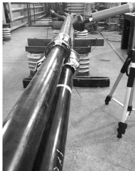
Рис. 5. Кабельная линия, проложенная «треугольником встык»
