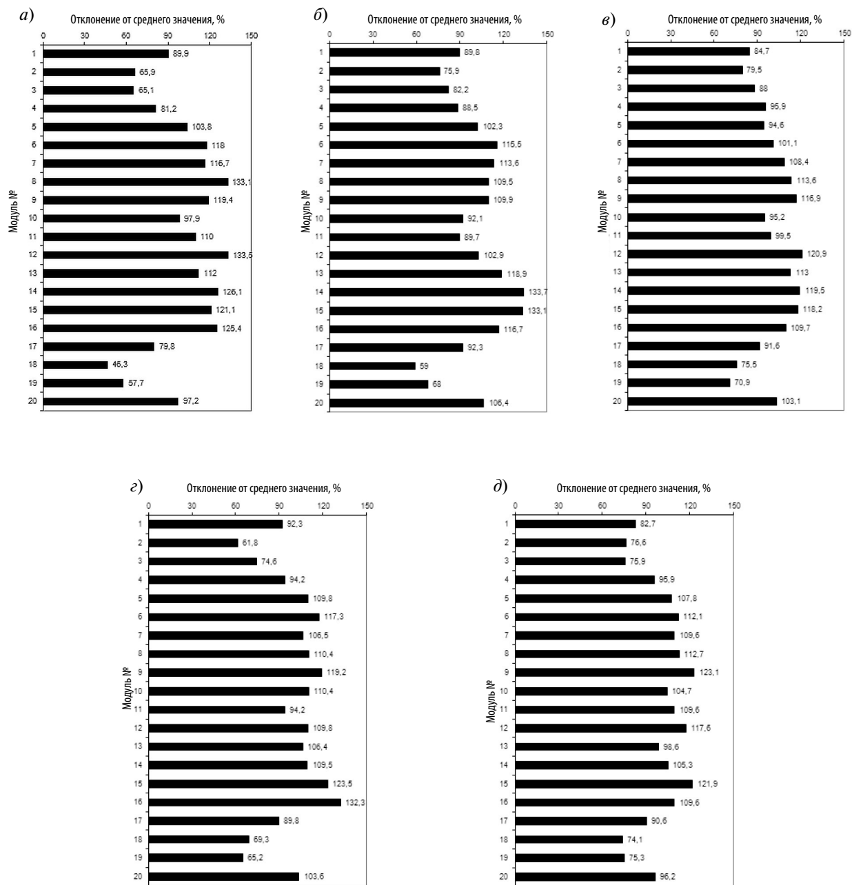
Рис. 3. Эпюры распределения скоростей воздуха по сепарационным блокам (результаты эксперимента, первый этап):
