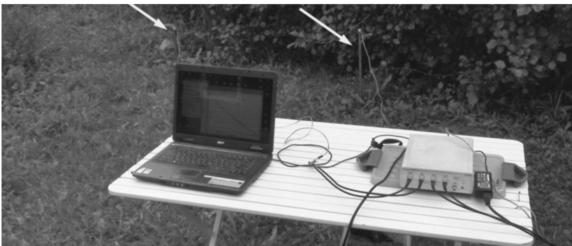
Рис. 5. Измерение импедансов дипольных антенн. Стрелками отмечены заземлители, изготовленные из трубок из нержавеющей стали
