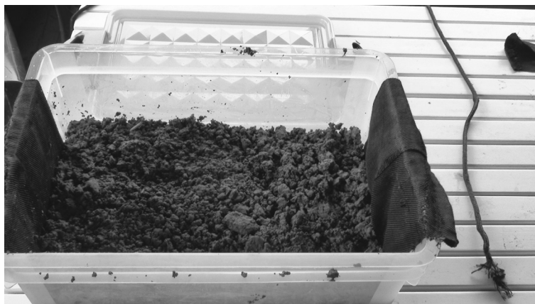
Рис. 2. Измерение электропроводности влажной глины с использованием в качестве торцевых электродов угольной ткани. Справа шнур из углеродного материала
