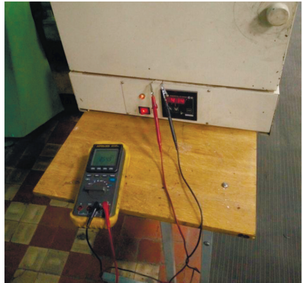
Рис. 3. Вывод фактической температуры на датчик при помощи термопары Fig. 3. The output of the actual temperature at the sensor using a thermocouple
