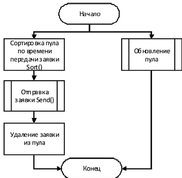
Рис. 4. Блок-схема алгоритма распределения заявок по каналам связи
