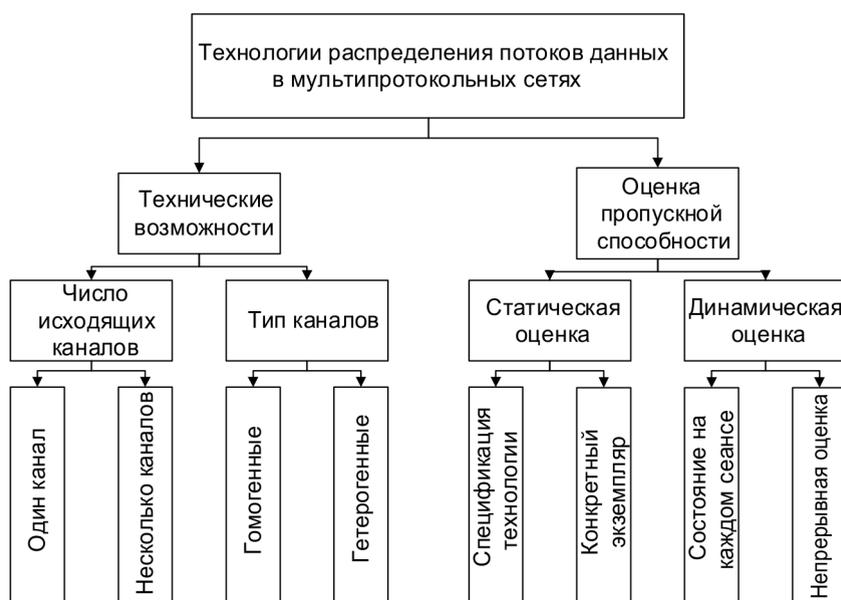
Рис. 1. Классификация технологий распределения потоков данных
