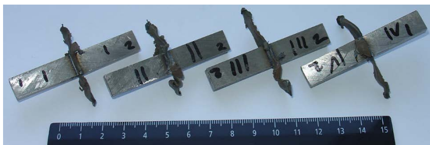
Рис. 1. Образцы титанового сплава Ti-6Al-4V после линейной сварки трением.
