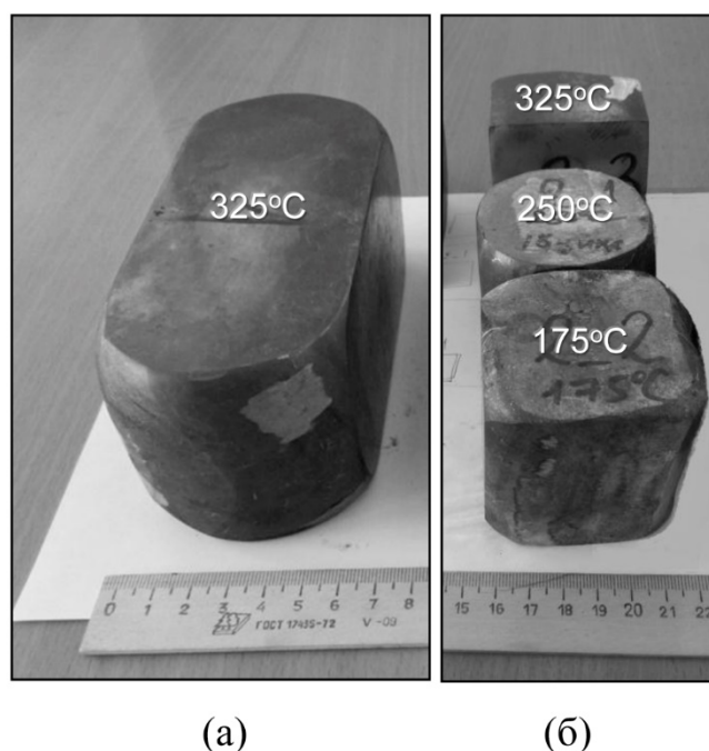
Рис. 2. Внешний вид исходной заготовки после первого этапа ВИК (а) и заготовок после ее резки и последующих этапов ВИК при соответствующих температурах (б).
