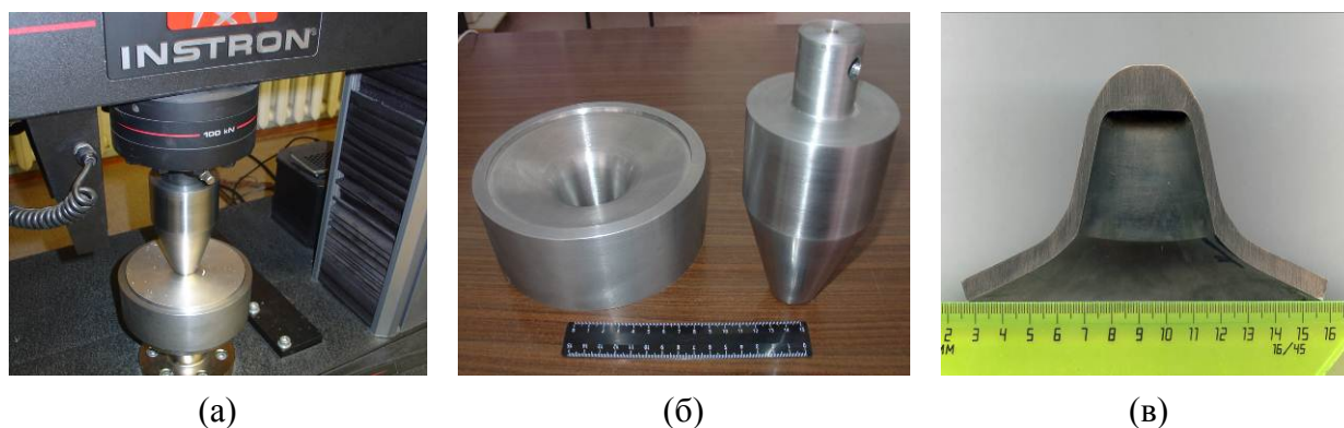
Рис. 3. Изготовление модельной заготовки из сплава Вуда: штамповка заготовки (а); оснастка для штамповки (б); осевой разрез заготовки (в).
