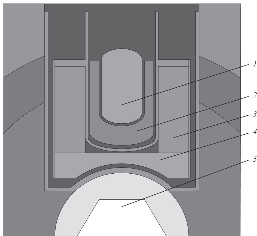
Рис. 1. Расположение источника ультрахолодных нейтронов (УХН) в тепловой колонне реактора ВВР-М:
