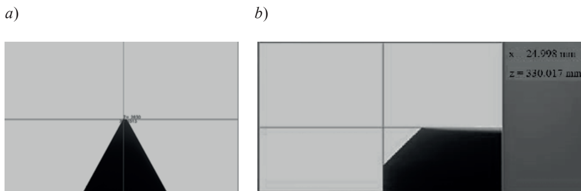
Рис. 4. Пример интерфейсов пользователя в режимах калибровки ( a ) и измерения ( b ) размера контура режущей кромки инструмента.
