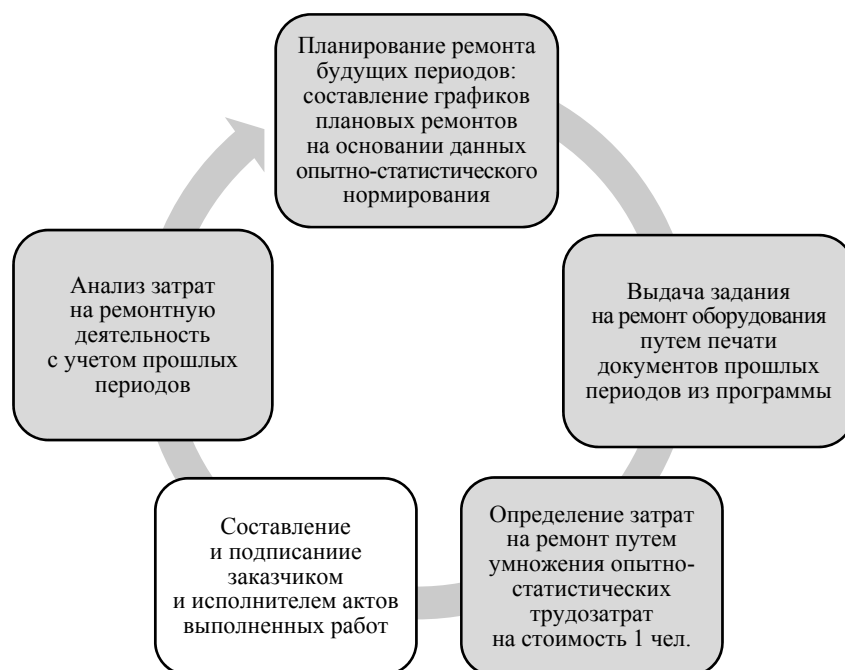
Рис. 4. Процесс формирования затрат на основании прошлых периодов (опытно-статистически) Fig. 4. The process of formation of costs based on past periods (experimental and statistical)
