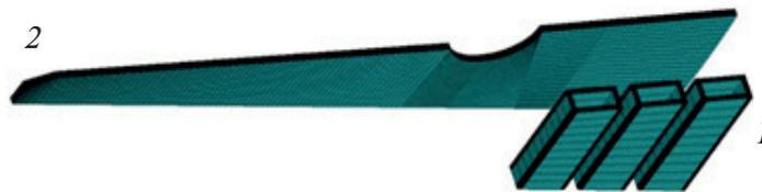
Рис. 2. Конечно-элементная 3D-система: 1 – индуктор, 2 – демпферная пружина
