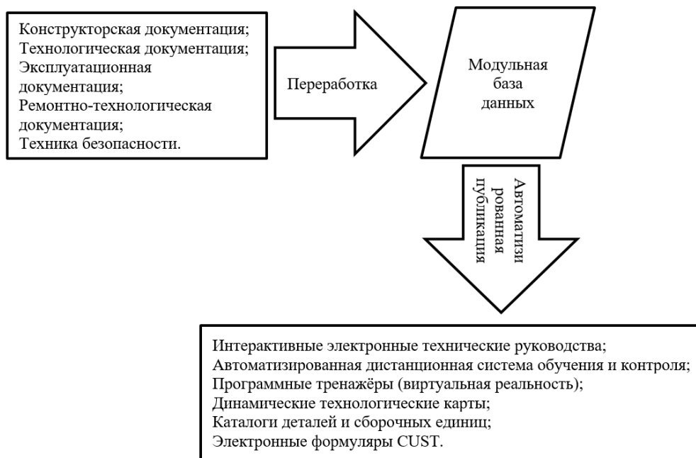
Рис. 5. Схема создания единой базы управления технической информацией по модульному принципу
