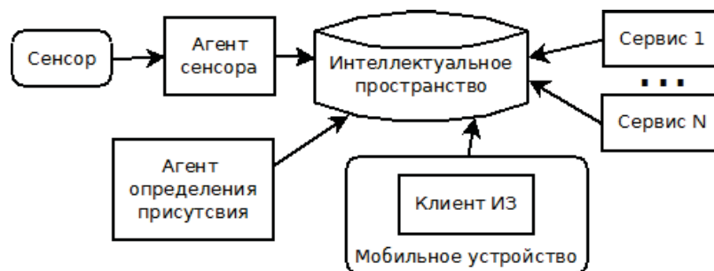
Рис. 1. Архитектура подсистемы обнаружения присутствия в системе ИЗ.
