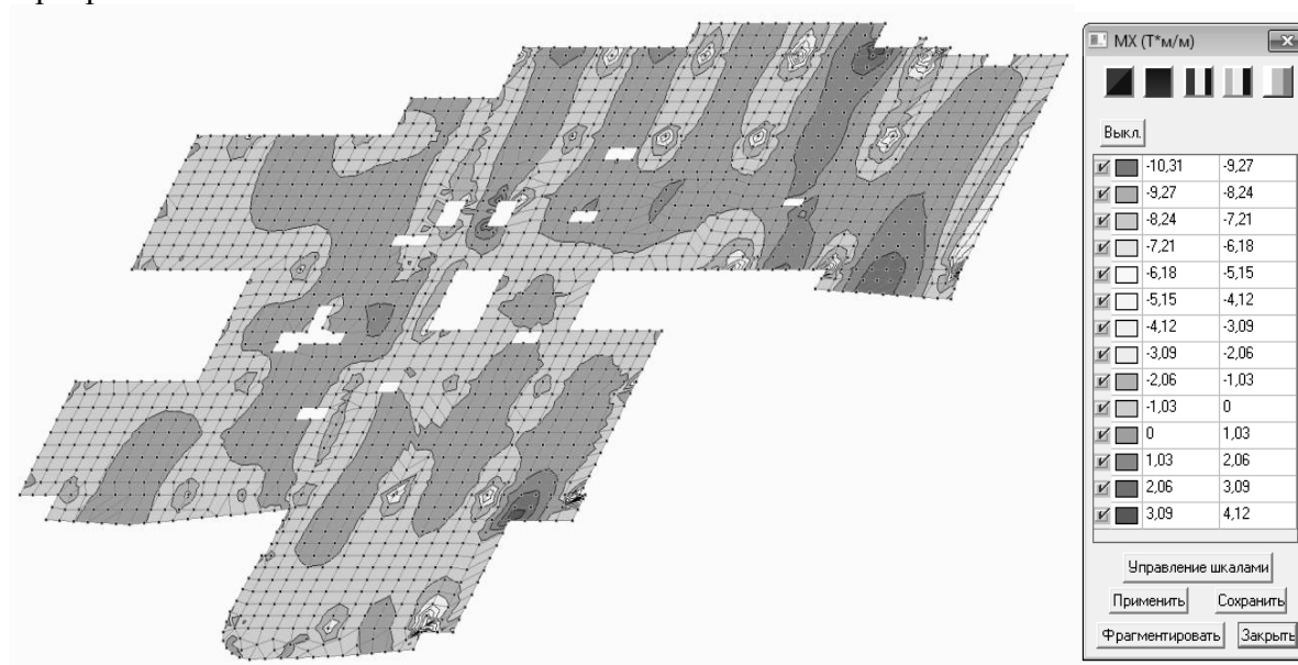
Рис. 2. Распределение изгибающих моментов по плите перекрытия
