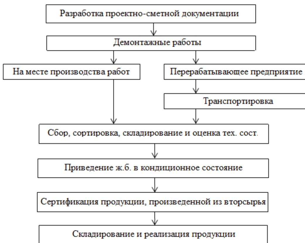
Рис. 2. Схема этапов комплексной переработки и использования вторичных ресурсов из железобетона
