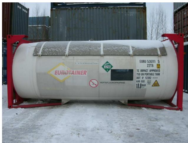
Рис. 4. Контейнер «Eurotainer» («ISO-танк»), содержащий 15 т хладона марки 227ea
