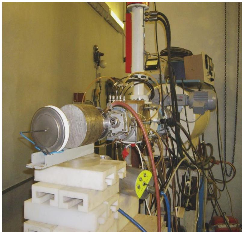
Рис.2. Гамма-нейтронное испытание элемента аппаратуры ИТЭР на циклотроне МГЦ-20
