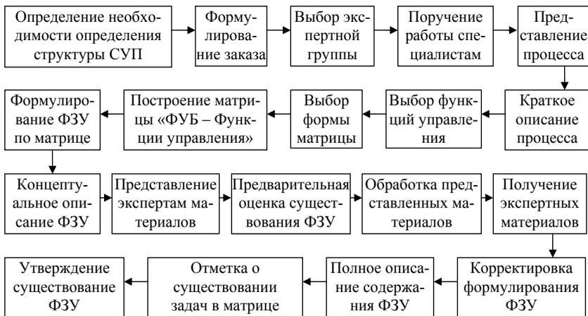
Рис. 3. Определение контуров СУП
