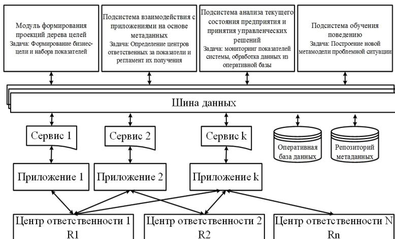
Рис. 2 – Структурная схема интегрированной информационной системы, обеспечивающая свойство поведения, где  $k$  – количество сервисов и приложений в ИС,  $N$  – количество центров ответственности
