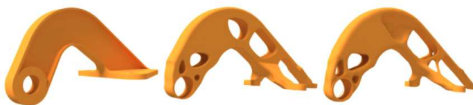
Рис. 1. Кронштейн, созданный с помощью топологической оптимизации. Материал был удален из областей, не несущих нагрузку
