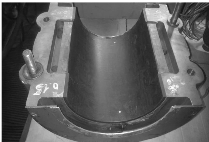
Рисунок 6 – Нижняя половина вкладыша подшипника из углепластика УПФС перед монтажом в турбину
