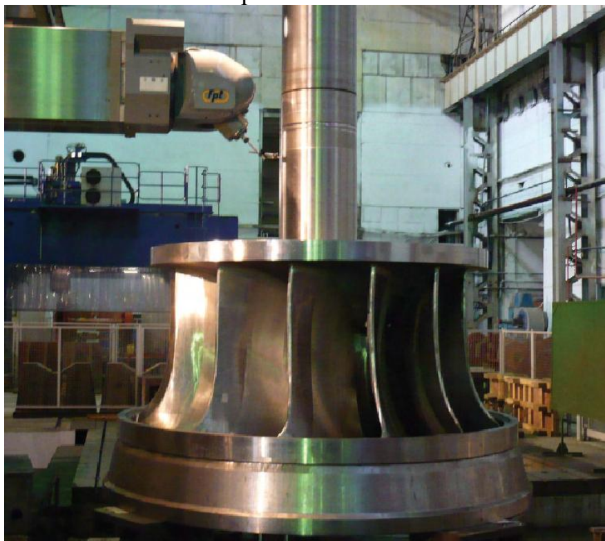
Рис. 5.14. Фотография изготовленной турбины 2 Широковской ГЭС
