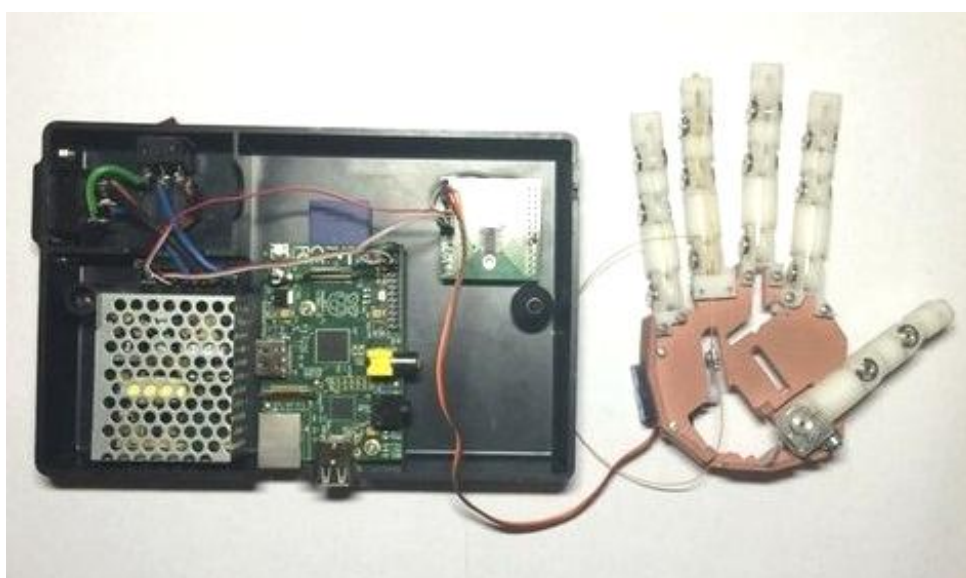
Рис. 36. Блок управления и механическая кисть руки.
