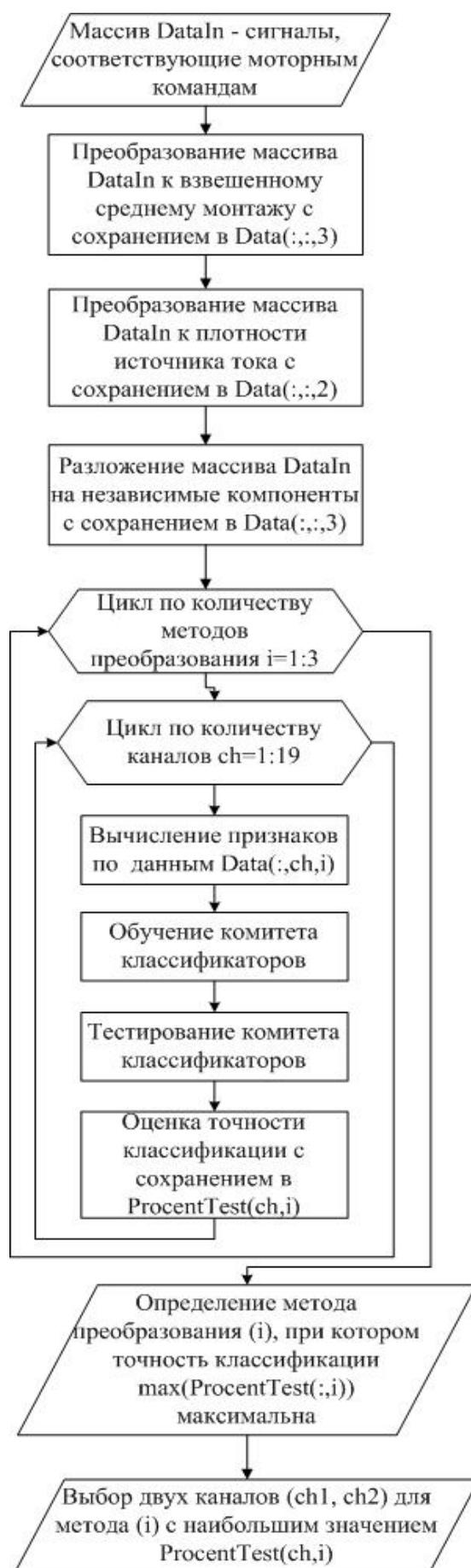
Рис. 22. Схема алгоритма преобразования и выбора информативных каналов.
