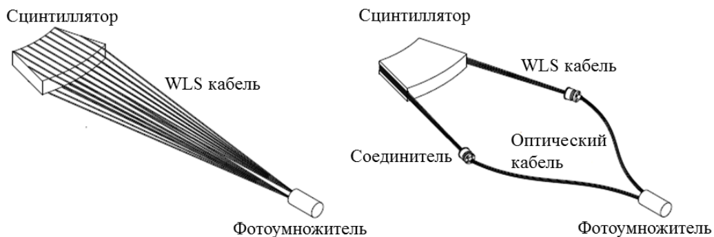
Рис. 2.2.1.6.1 Схематическое изображение детектирующих элементов V0A (слева) и V0C (справа) детекторов.
