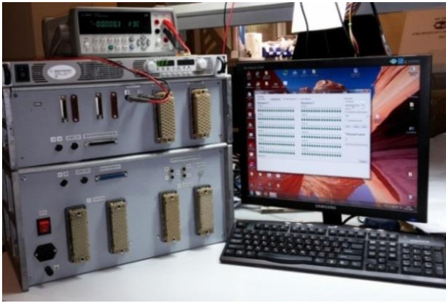
Рисунок 15. Измерительная система HP-31 для ресурсных испытаний
