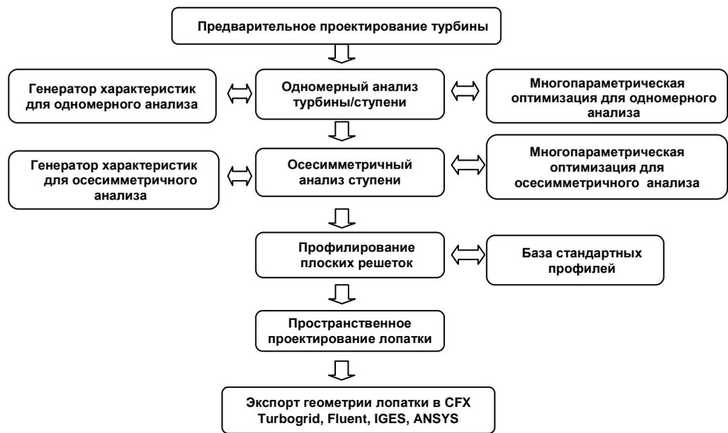
Рисунок 3. Структурная схема процесса проектирования проточных частей паровых турбин
